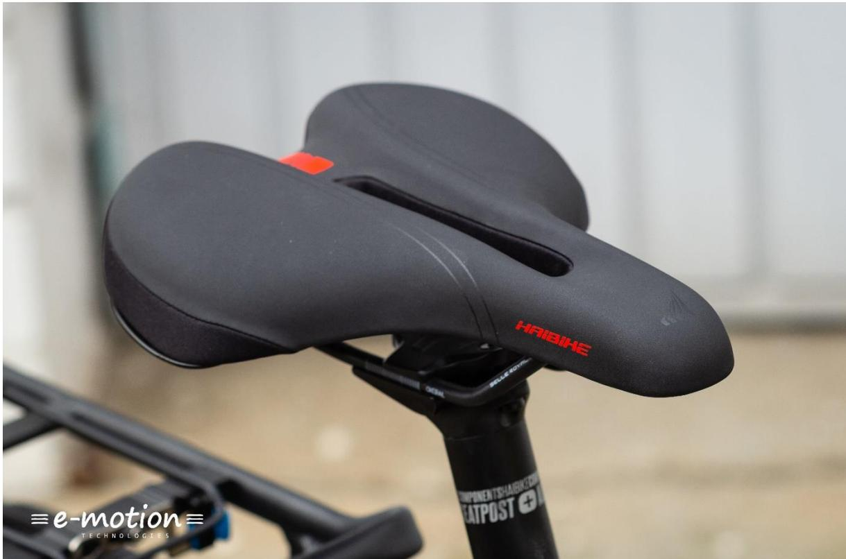
Der Seriensattel mit breiter Auflagefläche im hinteren Bereich der Sitzhocker verfügt über eine Aussparung im Mittelsteg und sorgt für Entlastung, besonders auf langen Touren.
