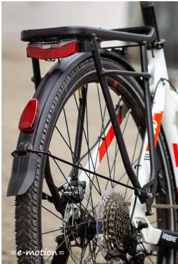
Betrachtet man das Heck des Trekking e-Bikes, fällt der massive Heckträger direkt ins Auge. Dieser kann bis zu 25 kg belastet werden und zur Anbringung von Radtaschen genutzt werden. Diese werden ganz unkompliziert eingehängt und werden durch die seitlichen Träger- und Führungsrohre ab Träger abgestützt.
