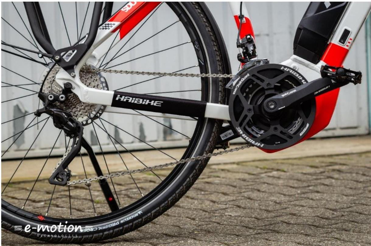
Durch die 10fach Kassette am hinteren Laufrad und das Zweifach-Kettenblatt am Yamaha PW-Antrieb ergeben sich 20 verschiedene Gänge zur Bestimmung der idealen Trittfrequenz. Die Schaltung und der Umwerfer am Haibike SDURO Trekking 6.0 stammen aus der hochwertigen XT-Klasse von Shimano und die Übersetzungsbandbreite beträgt 436%.
