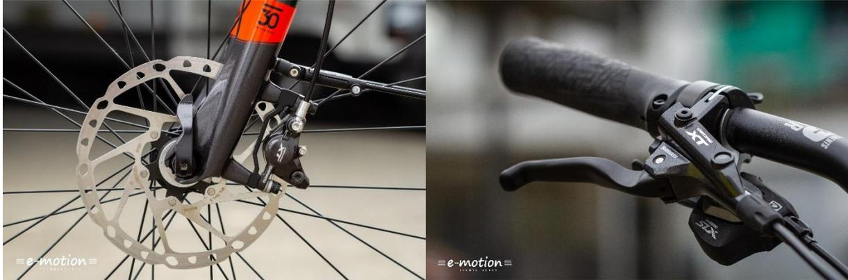
Die Shimano XT Bremse bestehend aus einer 180 mm Bremsscheibe am Vorderrad und einer 160 mm Bremsscheibe im Heck gehört zu den hochklassigen Bremsen und arbeitet zuverlässig. Parallel zum Shimano XT Bremsattel stammt auch der Bremshebel aus der XT Serie. Die mechanischen SchalttrIGGER zur Anwahl der Gänge sind aus der Shimano SLX Serie.
