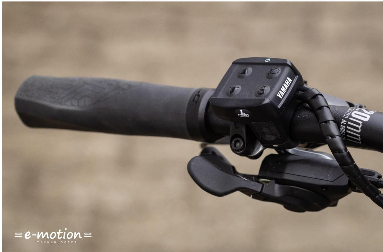
Die Steuerzentrale des Yamaha Antriebssystems ist eine Art kabelgebundene Fernbedienung und befindet sich an der linken Lenkerseite. An den Stirnseiten der Steuerzentrale befinden sich oben der Ein- und Ausschalter und unten der Knopf zur Aktivierung der Schiebehilfe. Auf der Oberseite sind die Knöpfe zur Wahl der Unterstützungsstufe und der Tachofunktionen sowie der Lichtschalter angebracht.
