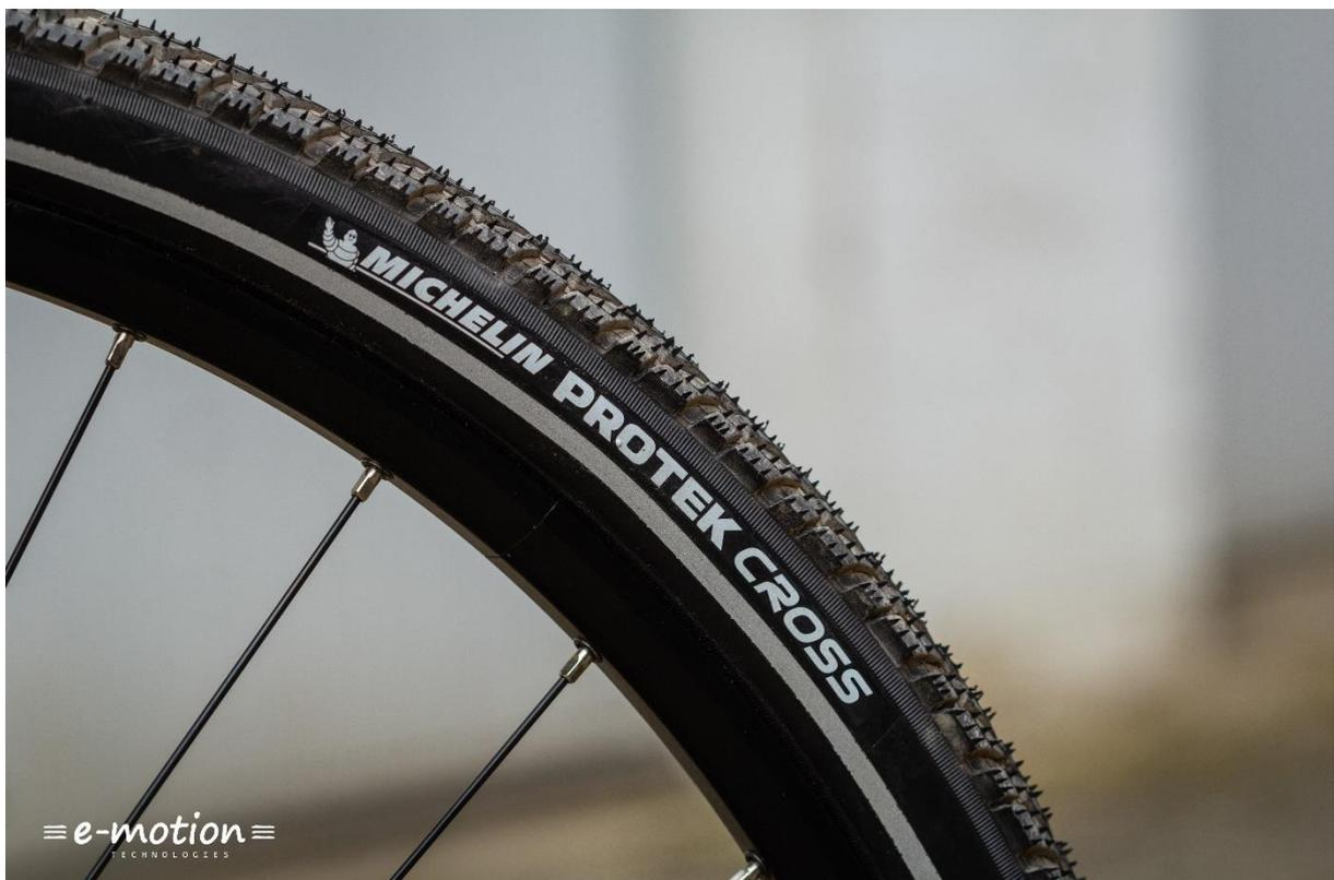
Ausgestattet mit Michelin Reifen in der Breite 1,6“ und leichter Profilierung, sorgt das Haibike SDURO Trekking 6.0 für Fahrsicherheit auf losen Untergründen wie Waldwegen und einen guten Lauf auf befestigten Strassen.
