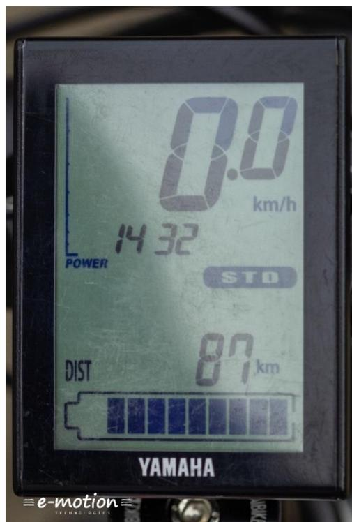
Das grosse, beleuchtete LCD Display des Yamaha PW e-Bike Systems ist zentral am Cockpit angebracht und besticht durch eine übersichtliche Gestaltung. Die wichtigsten Kerngrößen wie Geschwindigkeit, Uhrzeit, Reichweite, aktueller Unterstützungsgrad und Ladezustand werden leicht lesbar angezeigt, sodass der Fahrer die wichtigsten Daten während der Fahrt auf einen Blick erfassen kann.
