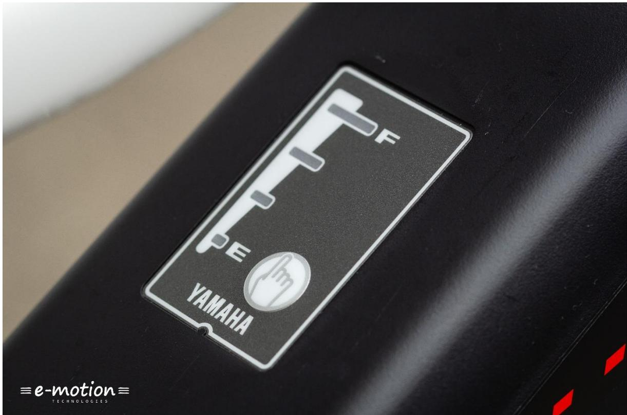
Das 500 Wh Akkupack des SDURO 6.0 besitzt den aktuell grössten Energiespeicher dieser Serie. Die LED Leiste auf der Oberseite des Akkus zeigt den aktuellen Sättigungszustand während des Ladevorgangs an. Der Ladevorgang mit dem 4 Ah Ladegerät dauert circa 3,5 Stunden, allerdings sind nach etwa 2,5 Stunden schon 80 % der Gesamtkapazität geladen.
