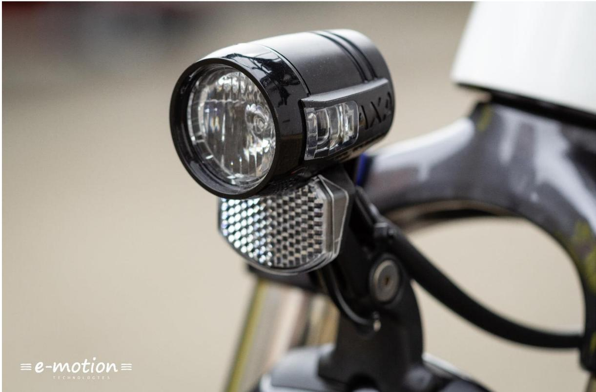
Die Frontbeleuchtung von AXA wird aus dem e-Bike System mit Energie versorgt und verfügt über eine Beleuchtungsstärke von 30 LUX. Selbst wenn der e-Bike Akku mal leer ist, funktioniert die Beleuchtung, da sie aus der niedrigeren Versorgungsspannung gespeist wird.
